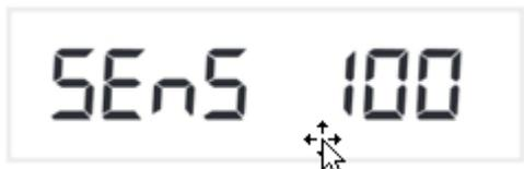
L'élément de menu Sensibilité est affiché sous **"Sens"** (sensitivity). Dans ce menu, la sensibilité de l'appareil peut être configurée.
